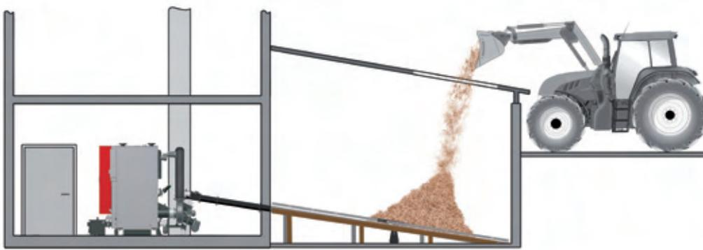
Der Lagerraum befindet sich ebenerdig zum Heizraum und kann meist durch einen kostengünstigen Zubau realisiert werden.
