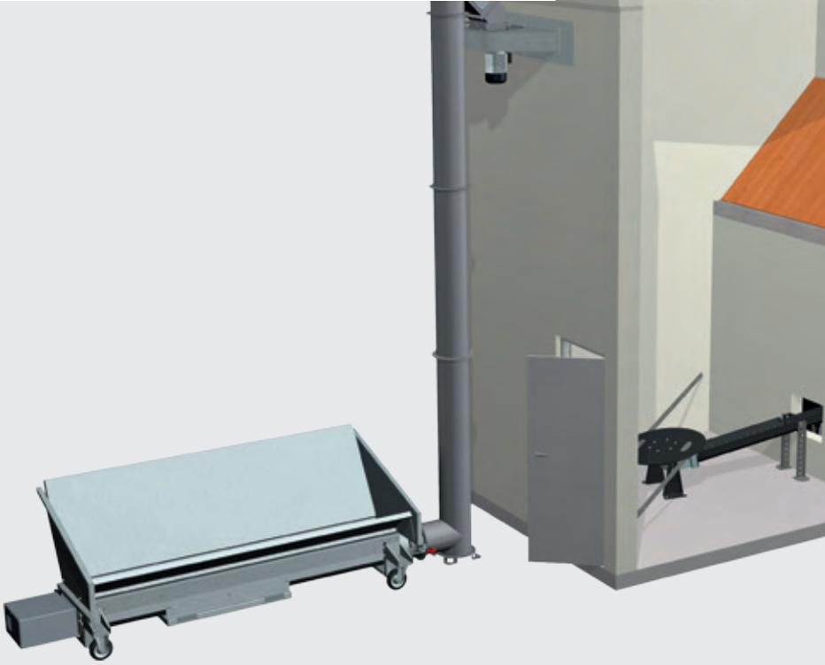
Die Senkrechtförderschnecke setzt neue Maßstäbe bei der Förderleistung ( $45 \text{ m}^3/\text{h}$ ), Betriebssicherheit, und beim Bunkerfüllgrad. Die Hack-schnitzel werden vom Aufnahme-trog mit einer Schnecke in die Förderanlage geschoben, die den Brennstoff auf die gewünschte Höhe zur Schleuderscheibe transportiert. Die Senkrecht-Förderschnecke ermöglicht so eine staubfreie Befüllung des Lagerraums und sorgt für eine gleichmäßige Verteilung des Brennstoffes im Lagerraum.
