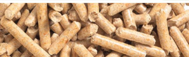
Holzpellets bestehen aus naturbelassenem Holz. Die in der Holzverarbeitenden Industrie als Nebenprodukt in großen Mengen anfallenden Hobel- und Sägespäne werden unbehandelt verdichtet und pelletiert. Durch die hohe Energiedichte und die einfache Liefer- und Lagermöglichkeit
