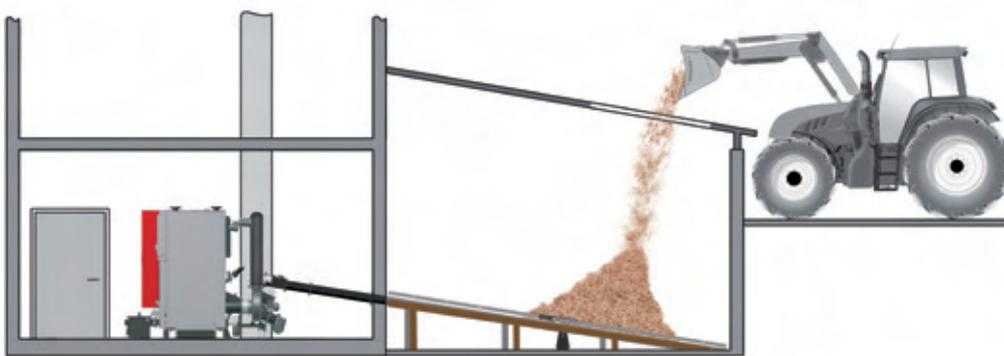
Der Lagerraum befindet sich außen unterhalb des Zufahrtniveaus. Der Brennstoff wird von oben in den Lagerraum gekippt. Der Brennstofflagerraum kann meist durch einen kostengünstigen Zubau realisiert werden.
