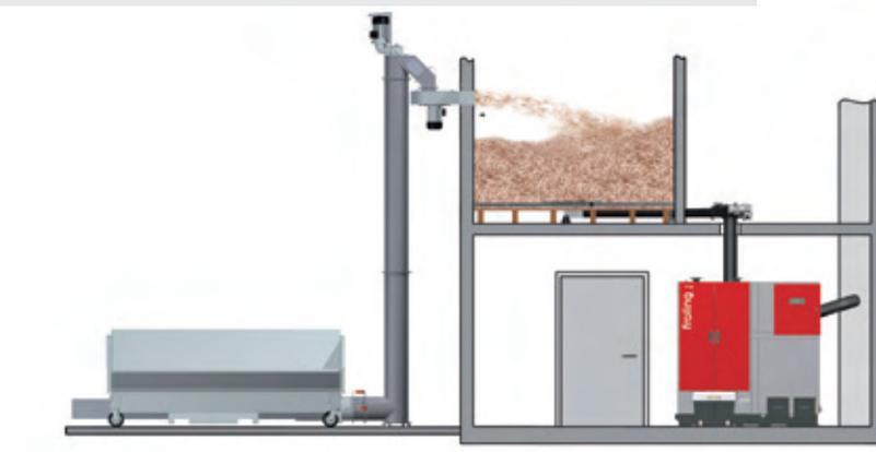
Der Lagerraum befindet sich oberhalb des Heizraums. Die Brennstoffzufuhr zum Kessel wird über ein Fallrohr realisiert. Der Einsatz einer Zelleradschleuse wird hier empfohlen. Der Lagerraum kann mit Hilfe der Senkrechtförderschnecke oder durch Einblasen des Brennstoffes komfortabel befüllt werden.
