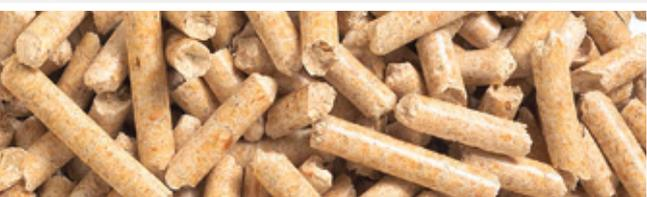
Il pellet è un prodotto non trattato. Gli scarti come i trucioli e la segatura dell'industria del legno vengono compressi e pellettizzati senza aggiunta di altri materiali. Grazie all'elevata densità energetica e alle semplici possibilità di fornitura e deposito, il pellet si rivela il combustibile ideale per gli impianti di riscaldamento completamente automatici.
