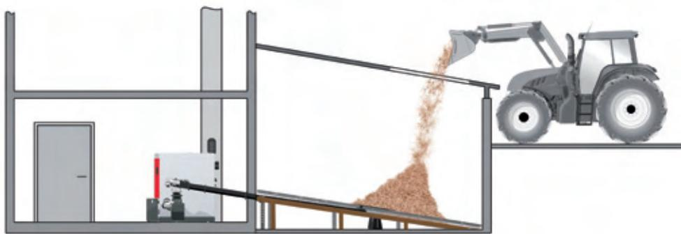
Il deposito si trova sotto il livello di accesso veicolare. Il combustibile viene ribaltato nel deposito dall'alto. Il deposito di combustibile può essere realizzato perlopiù tramite un ampliamento economico. Il ripiano intermedio illustrato non è strettamente necessario dal punto di vista tecnico.
