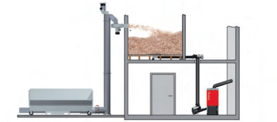
Il deposito si trova sopra il livello del locale caldaia. Il caricamento di combustibile alla caldaia viene realizzato mediante un tubo di caduta. La valvola a stella obbligatoria è già compresa nello standard di fornitura. Il deposito può essere riempito comodamente con la coclea di trasporto verticale o tramite immissione del combustibile.
