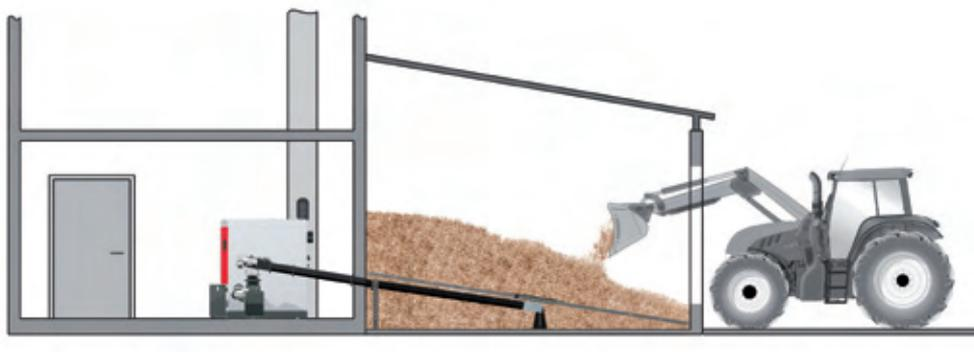
Il deposito, collocato a livello del suolo rispetto al locale caldaia, può essere realizzato perlopiù tramite un ampliamento economico.
