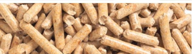
Il pellet è un prodotto non trattato. Gli scarti come i trucioli e la segatura dell'industria del legno vengono compressi e pellettizzati senza aggiunta di altri materiali. Grazie all'elevata densità energetica e alle semplici possibilità di fornitura e deposito, il pellet si rivela il combustibile ideale per gli impianti di riscaldamento completamente automatici. Il rifornimento del pellet avviene mediante un'autocisterna che riempie direttamente il deposito.
