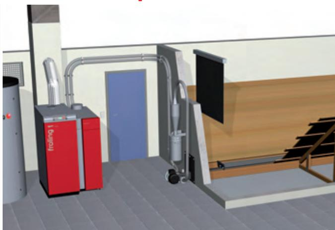
Questo sistema colpisce per il facile montaggio e l'elevata flessibilità. Il sistema di aspirazione universale supera anche eventuali grandi distanze tra il deposito e il locale caldaia. La posizione delle sonde di aspirazione o del gruppo di traslazione (Pellets Box) può essere personalizzata in base alle condizioni esistenti del deposito.
