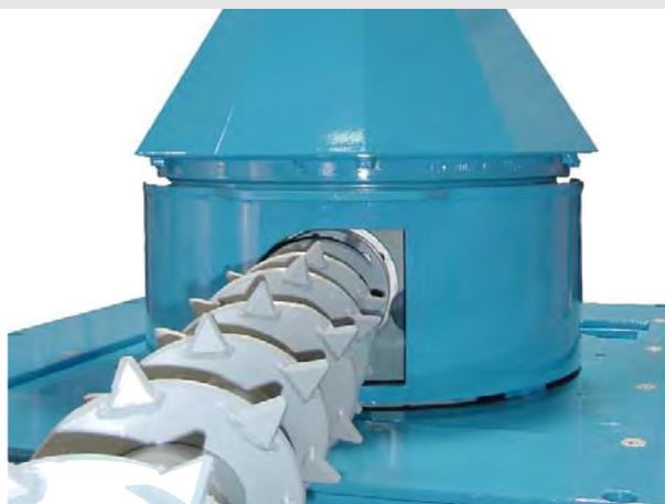
Struttura massiccia in grado di sopportare pesi specifici apparenti estremi tipici dei sistemi di estrazione da silo a torre. Trova particolare applicazione per i trucioli e per i locali stoccaggio di maggior diametro.
