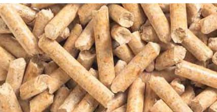
Il pellet è un prodotto di legno naturale. Gli scarti come i trucioli e la segatura dell'industria del legno vengono compressi e pellettizzati senza aggiunta di altri materiali. Grazie all'elevata densità energetica e alle semplici possibilità di fornitura e deposito, i pellet si rivelano i combustibili ideali per gli impianti di riscaldamento completamente automatici. Il rifornimento dei pellet avviene mediante un'autocisterna che riempie direttamente il deposito.
