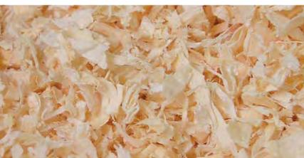
I trucioli, residui e sottoprodotti della lavorazione del legno, per questo settore rappresentano quindi il logico combustibile. Le proprietà di questo combustibile straordinariamente secco richiedono una tecnica di combustione particolarmente solida.
