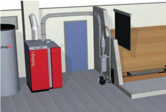
Das Fröling Schneckensaugsystem ist die ideale Lösung für rechteckige Räume mit stirnseitiger Entnahme. Durch die tiefe und waagrechte Position der Austragschnecke wird das Raumvolumen optimal genutzt und eine vollständige Entleerung des Lagerraumes ist gewährleistet. Die Kombination mit dem Saugsystem von Fröling ermöglicht darüber hinaus eine flexible Aufstellung des Kessels.
