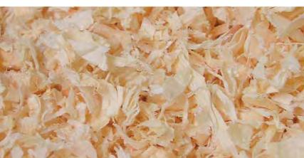
Späne fallen in der Holzverarbeitenden Industrie als Reststoff und Nebenprodukt an und sind somit der logische Brennstoff für diese Industrie. Die Eigenschaften dieses außergewöhnlich trockenen Heizmaterials erfordern eine besonders robuste Verbrennungstechnik.
