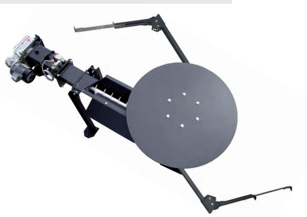
Zum Austragen von Brennstoffen aus Bunker mit einem maximalen Arbeitsdurchmesser von 6,0 Meter. Das System ist wartungsarm und speziell für Brennstoffe konzipiert, die auf Grund geringer Rieselfähigkeit eine erhöhte Austragsleistung benötigen. Dabei gewährleistet der patentierte Aufbau einen geräuscharmen und effektiven Betrieb.
