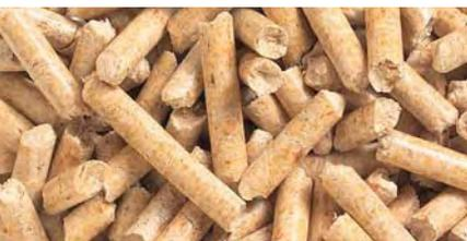
Holzpellets bestehen aus naturbelassenem Holz. Die in der Holzverarbeitenden Industrie als Nebenprodukt in großen Mengen anfallenden Hobel- und Sägespäne werden unbehandelt verdichtet und pelletiert. Durch die hohe Energiedichte und die einfache Liefer- und Lagermöglichkeit erweisen sich Pellets als der optimale Brennstoff für vollautomatische Heizanlagen. Die Lieferung der Pellets erfolgt mittels Tankwagen, von dem aus der Lagerraum direkt befüllt wird.
